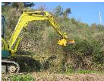
Immagine esemplificativa del miniescavatore con frullino al terminale
